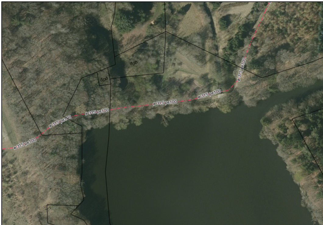
Figur 13. Luftfoto 2022, © DAF. Spildevandsledningens placering i spærredæmningen (rød streg).
