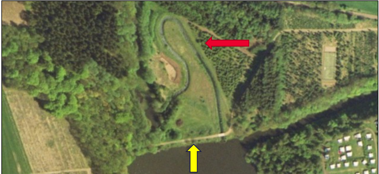
Figur 4. Orthofoto 1999 © Hexagon. Spærredæmning og omløbsstryget ved Bredvad sø. Spærredæmning angivet med gul pil og omløbsstryg angivet med rød pil.
