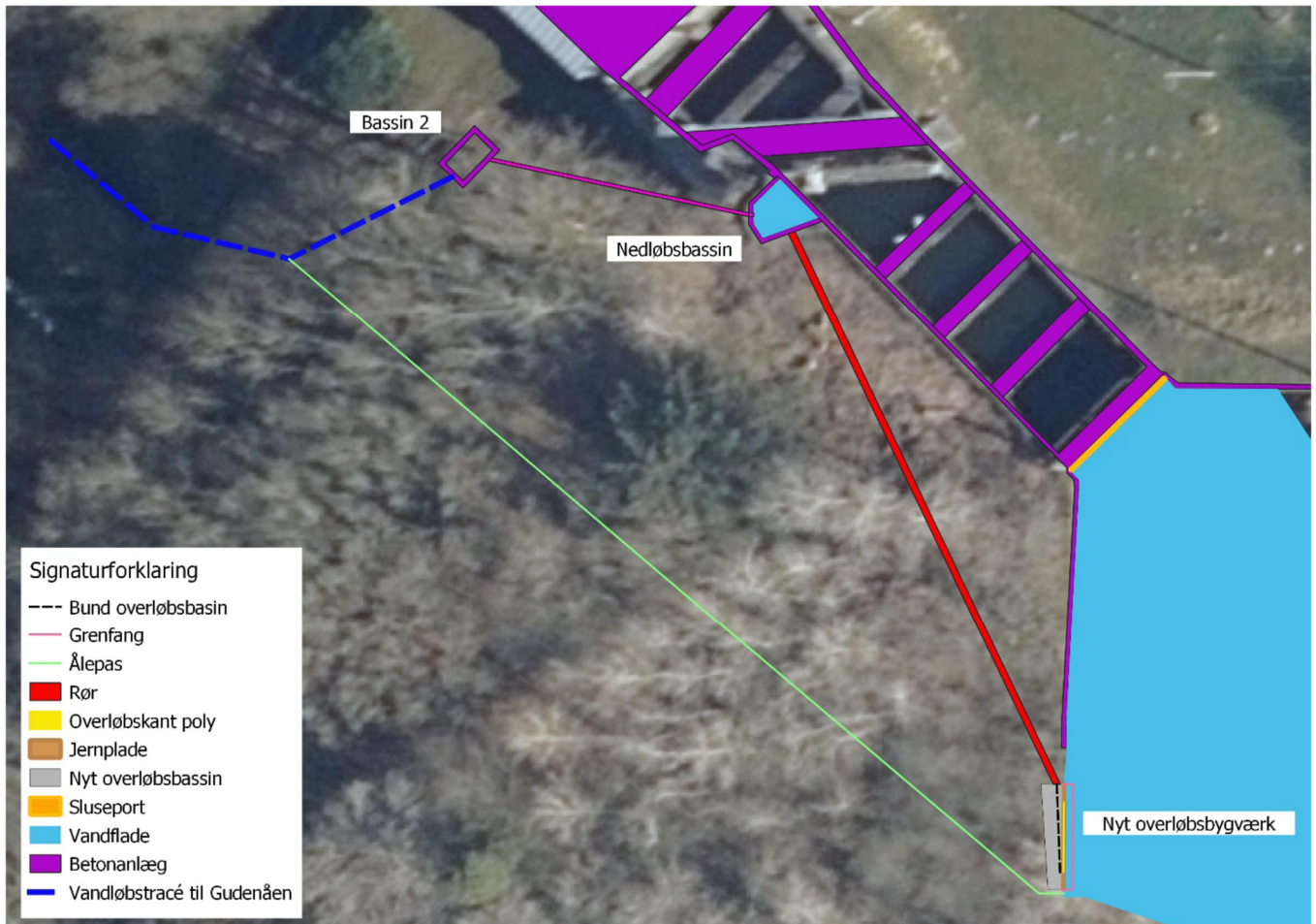
Figur 37. Placering og forløb af Ålepas og overløb fra vestbirksøerne.
